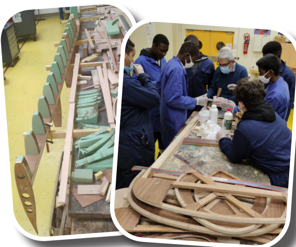
Construction d'un biplace JPM 04 Drakkar, conception française en bois.
